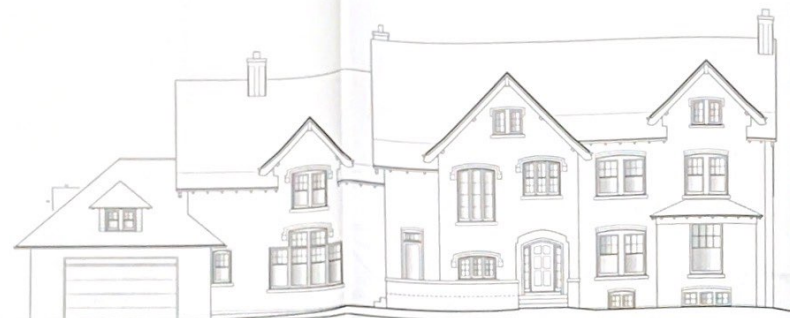
1 EXISTING FRONT/WEST ELEVATION D1 Scale: 1/8" = 1'-0"
